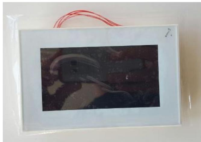
Fig. 11. Pantalla táctil 4,3'' para controlar y monitorizar el Busing
