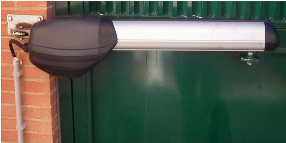
*Fig. 10. Brazo mecánico apertura puerta a motor.*
